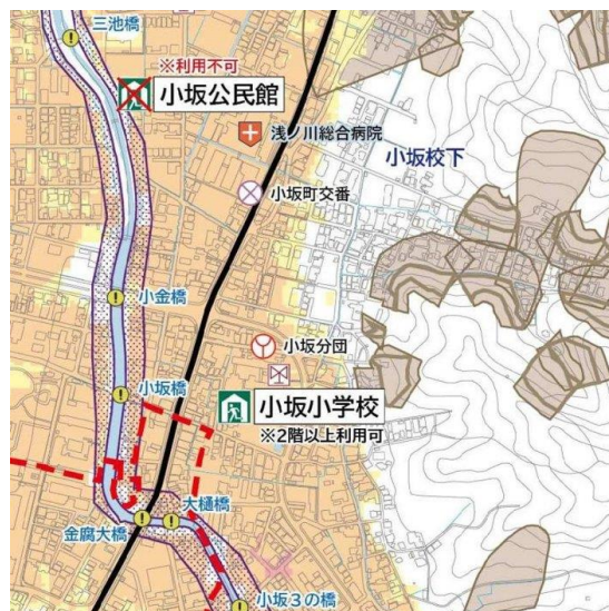
当院周辺の洪水浸水想定（想定最大規模） オレンジ：0.5～3.0m／黄：0～0.5m／茶：土砂災害警戒区域 出典：金沢市水害ハザードマップ「小坂校下（北部）」
